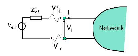
$$egin{aligned} V_i^- &= V_i^+ + V_i^-, & I_i^- &= I_i^+ + I_i^- \ V_i^+ &= Z_{c,i} I_i^+, & V_i^- &= -Z_{c,i} I_i^- \end{aligned}$$
