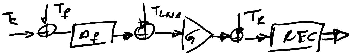
$$-T_{sys} = T_a + T_f + T_{LNA} \cdot A_f + \frac{T_R \cdot A_f}{G}$$
